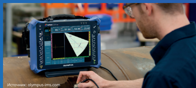
Неразрушающий контроль сварных соединений входит в систему обязательного объективного контроля качества магистралей
